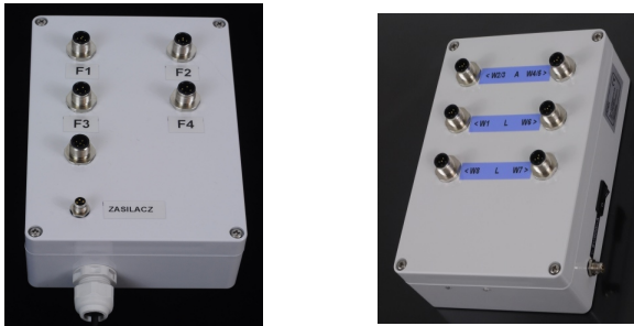
Rys. 1 Przykładowy widok systemu AV32G2 z gniazdami M12 oraz komunikacją USB/LAN (zdjęcie lewe) oraz komunikacją Radiową Wi-Fi (zdjęcie prawe).
